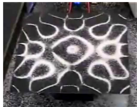
Fig. B-9. Chladni Pattern
